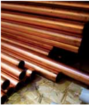
Leitungen aller Art sind leider auch immer Schalleiter. Das sollte bei Planung und Montage berücksichtigt werden. (© Rainer Sturm / PIXELIO)
