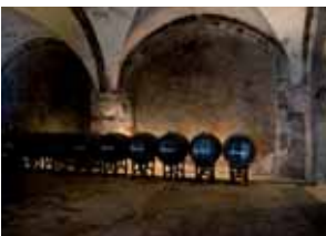
Jede Raumform hat andere Wirkungen. Das Gewölbe reflektiert die Schallwellen so, dass ein Gespräch recht anstrengend wird. Wie jeder weiß, der schon einmal in einem Stifts- oder Weinkeller war. Andererseits läßt der Quader die Schallwellen zwischen seinen parallelen Wänden hin und her pendeln, erhöht dadurch die Lautstärke und senkt durch Mehrfachinformation die Sprachverständlichkeit, besonders bei schallharten Oberflächen. (© Uwe Todte / PIXELIO)
